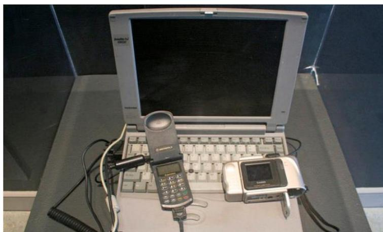
**Figura 2. Aparato mecânico, feito por Philippe Kahn para o primeiro registro de uma imagem por meio de um celular, em 1997.**
